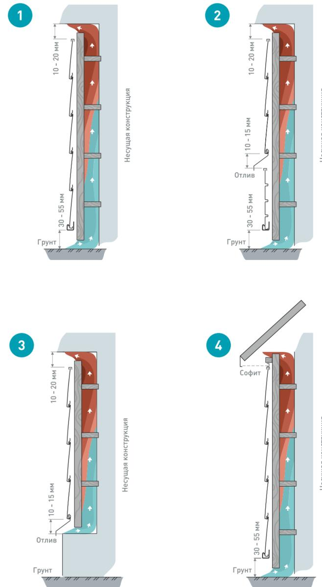
Варианты креплений навесного вентиляруемого фасада с вариантами вентиляруемых зазоров
