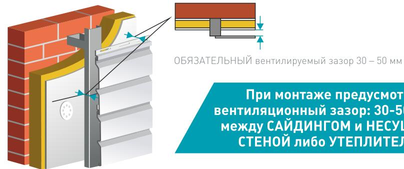
**При монтаже предусмотреть вентиляционный зазор: 30-50 мм между САЙДИНГОМ и НЕСУЩЕЙ СТЕНОЙ либо УТЕПЛИТЕЛЕМ.**
