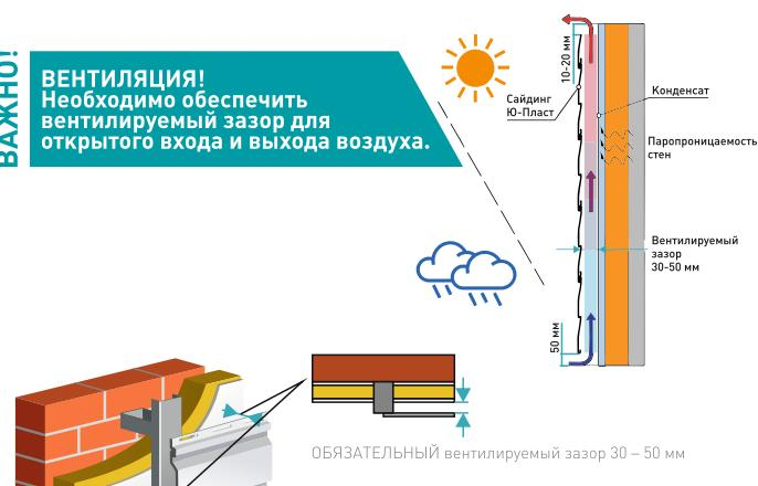
При монтаже предусмотреть вентиляционный зазор: 30-50 мм между САЙДИНГОМ и НЕСУЩЕЙ СТЕНОЙ либо УТЕПЛИТЕЛЕМ.
