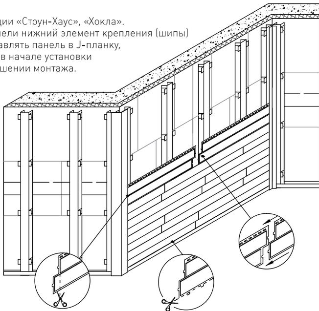
Соединение торцевого «шип-паз» замка обязательно производить на вертикальном элементе обрешетки. В случае отсутствия возможности попадания стыковки на обрешетку, необходимо дополнительно смонтировать вертикальный элемент обрешетки.
